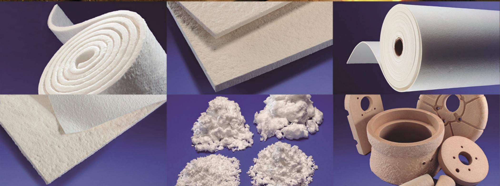
Los materiales de **Fibra Refractaria** son capaces de resistir las condiciones del medio en el que está inmerso sin alteraciones importantes en sus propiedades físico-químicas. Las condiciones del medio no incluyen únicamente el efecto de la temperatura, sino también la resistencia al ataque por fundidos, al choque térmico, su baja conductividad térmica y su bajo almacenaje de calor. La baja conductividad es muy favorable para temperaturas bajas y medias, no tanto para las altas.
