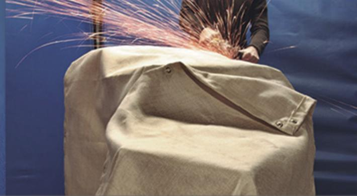
Son telas de filamentos en continuo de fibra de vidrio "E" texturizado, con un tratamiento térmico llamado comúnmente **Caramelizado**. Se trata de un proceso térmico que elimina aglutinantes y filamentos rotos del tejido, elimina las fibras volátiles y desenreda las fibras, reduciendo de las emisiones de humos y las posibles irritaciones cutáneas y respiratorias que tiene la fibra de vidrio sin tratar.
